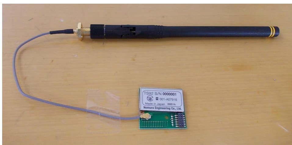
外部アンテナ（EXT1: ANT916-CW-HWR）
