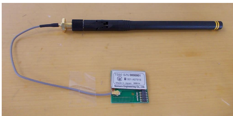
外部アンテナ（EXT1: ANT916-CW-HWR）
