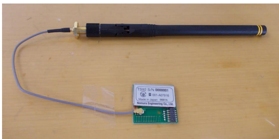
外部アンテナ（EXT1: ANT916-CW-HWR）
