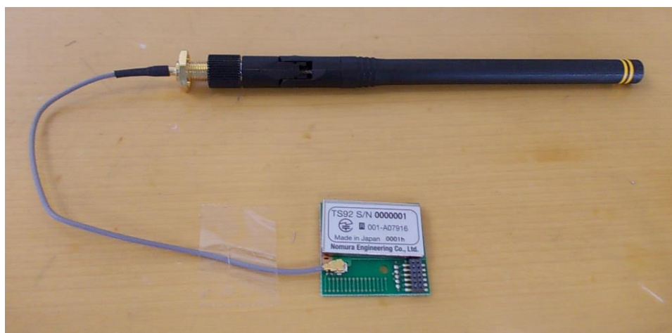
外部アンテナ（EXT1: ANT916-CW-HWR）
