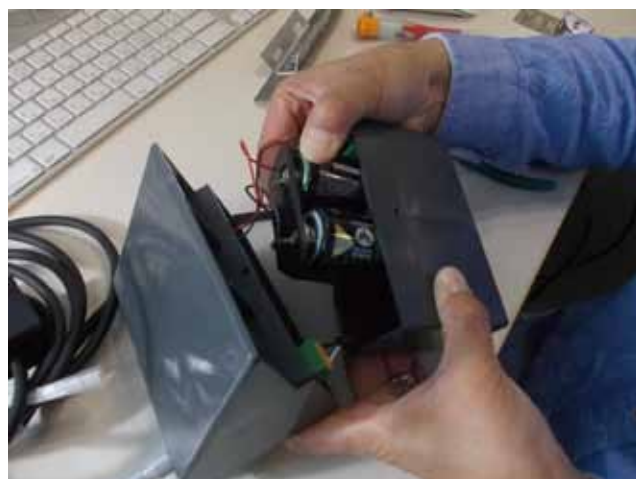
1) 下ケースからバッテリーホルダーを取り出して、単1電池を交換する。
