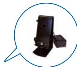
1) 下ケースからバッテリーホルダーを取り出して、単1電池を交換する。
