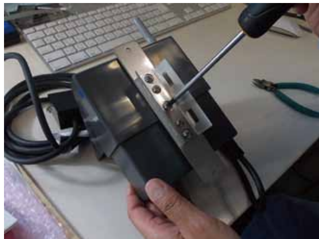
2) 裏面のネジを外す。 (中央の長いネジと一番下のネジ)
