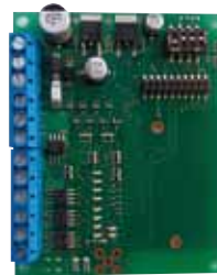
TS02-8swRXBDS 8接点用スクリーン端子台ボード*
