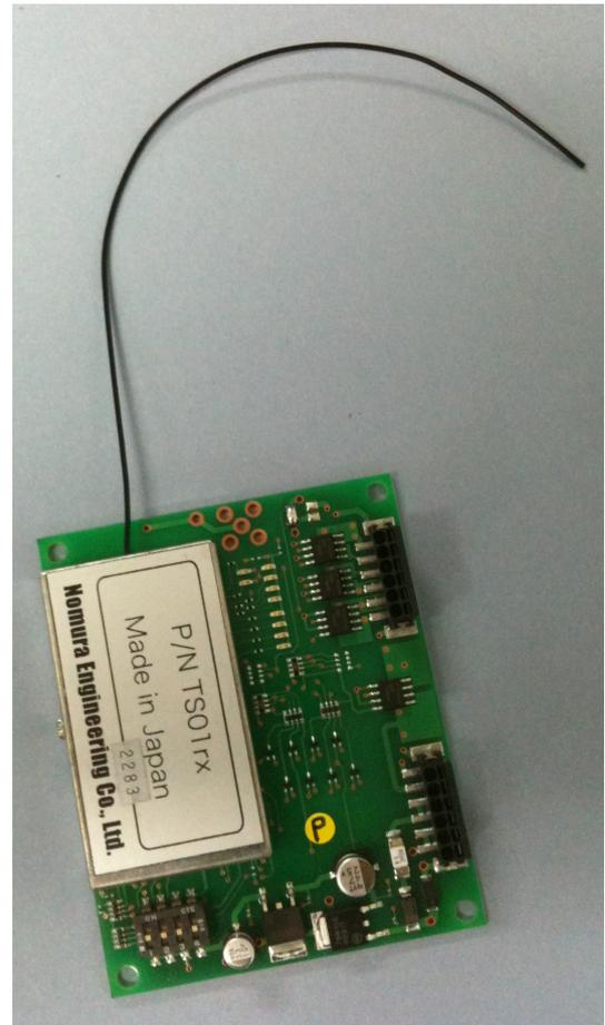
送信機をオンすると対応する出力端子IO1からIO8がアクティブとなりLEDが点灯します。
