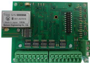
*モジュール、16I/O実装時。
