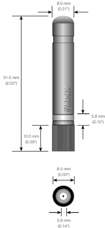
(注意)1/4 波長アンテナですので、グラウンドプレーンがない場合性能が劣化します。
